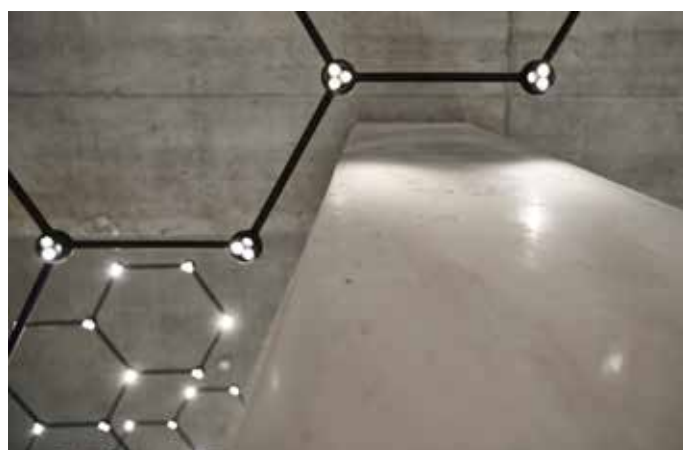
Abb.: Die drei Spots leuchten mit einem Abstrahlwinkel von je 18°, angeordnet mit 30° Neigung in gegenläufige Richtungen. Eine weitere Linse auf der Oberseite ermöglicht zuschaltbares, indirektes Licht.
